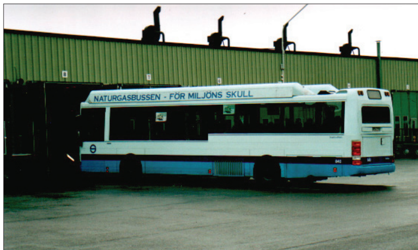
Rys. 4.1. Autobus CNG ze zbiornikami na dachu (zajezdnia w Göteborgu)
